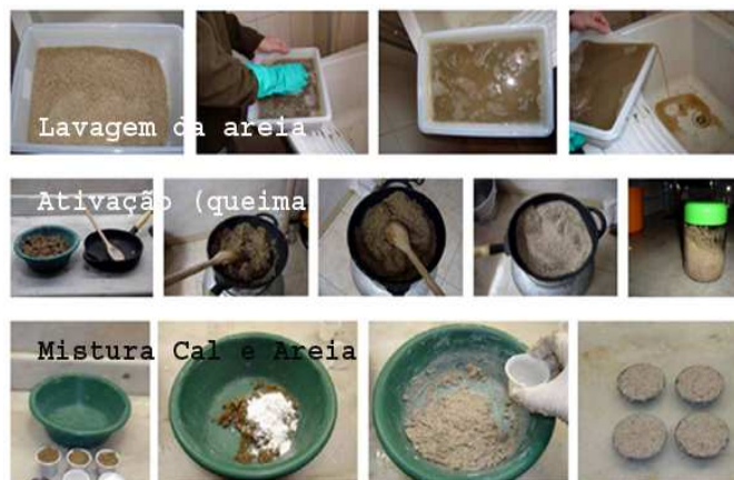
Img. 14 - Procedimentos de lavagem de areia (eliminação de impurezas e contaminações orgânicas), de ativação (queima) e de testes de traços de argamassas para revestimentos especiais. Fonte: CECI
