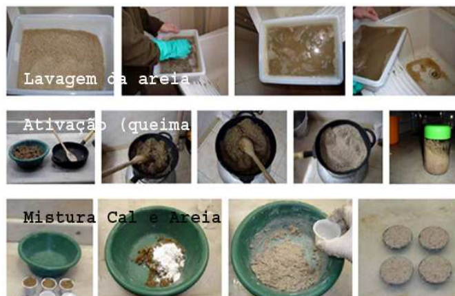
Img. 14 - Procedimentos de lavagem de areia (eliminação de impurezas e contaminações orgânicas), de ativação (queima) e de testes de traços de argamassas para revestimentos especiais. Fonte: CECI
