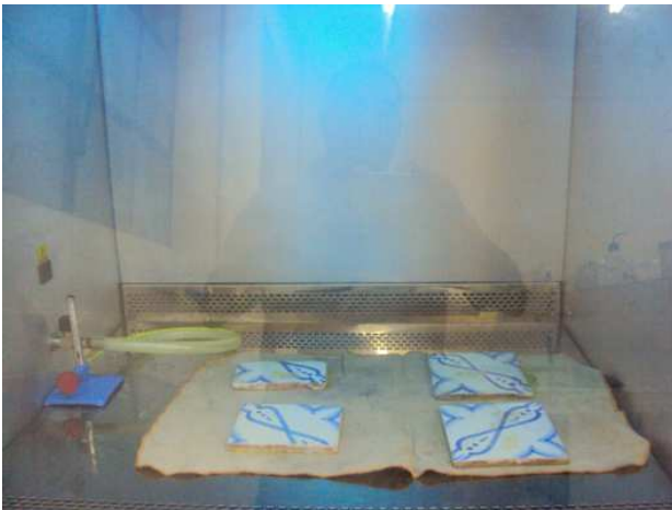
Img. 15 – Foram aplicados vários testes de aceleração de envelhecimento, dentre eles incidência de UV. O horizonte nesta câmara foi de 43 anos para manifestação de deterioração no enxerto (vide imagem ao lado). Fonte: CECI/2010.
