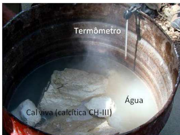
Img. 13 - Extinção da cal calcítica CH-III para hidratação e maturação durante três ou mais anos. O processo exotérmico deve apresentar temperaturas entre 95C° e 100C°. Fonte: CECI
