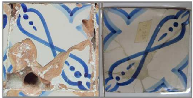
Img. 16 – Exemplos de um dos tipos de danos nos azulejos e do resultado dos testes de aceleração de envelhecimento em laboratório. Fonte: CECI/2010.
