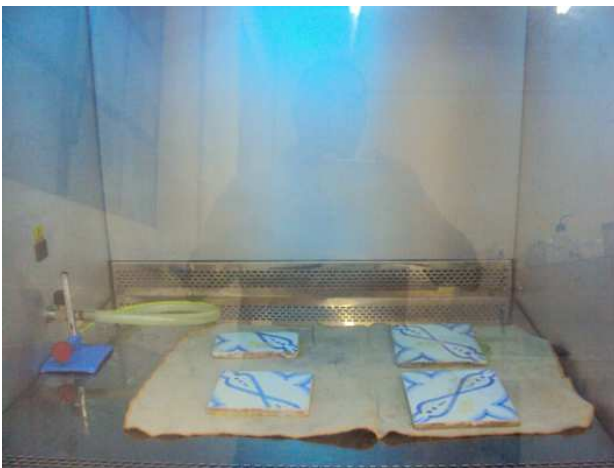
Img. 15 – Foram aplicados vários testes de aceleração de envelhecimento, dentre eles incidência de UV. O horizonte nesta câmara foi de 43 anos para manifestação de deterioração no enxerto (vide imagem ao lado). Fonte: CECI/2010.
