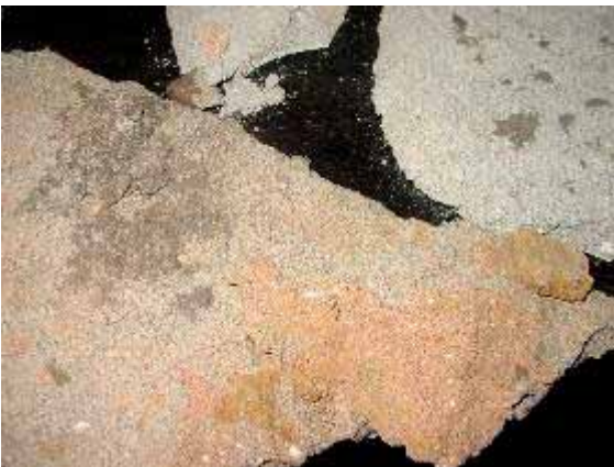
Figs. 25 e 26 – Pedacos de rebocos retirados de prospecções, devidamente selecionados, classificados e identificados, prontos para serem ensacados e enviados ao laboratório para os procedimentos de análises. Fonte: CECI, Igreja da Madre Deus –2004/05.
