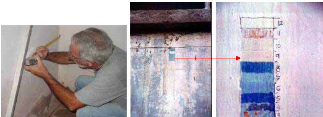
Figs. 21, 22 e 22a. – Marcação de área 30 x 30cm para remoção de rebocos para investigação de anomalias nas alvenarias 27 Fonte: CECI - 2005; janela de 17 x 5cm de investigação das camadas pictóricas 28 Fonte: Simone Arruda - 2004.
