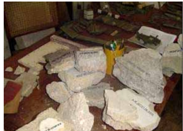
Figs. 25 e 26 – Pedacos de rebocos retirados de prospecções, devidamente selecionados, classificados e identificados, prontos para serem ensacados e enviados ao laboratório para os procedimentos de análises. Fonte: CECI, Igreja da Madre Deus –2004/05.
