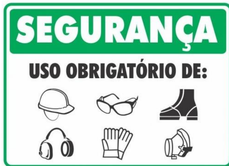
Figura 99 - Exemplo de sinalização de segurança - uso obrigatório de EPIs
